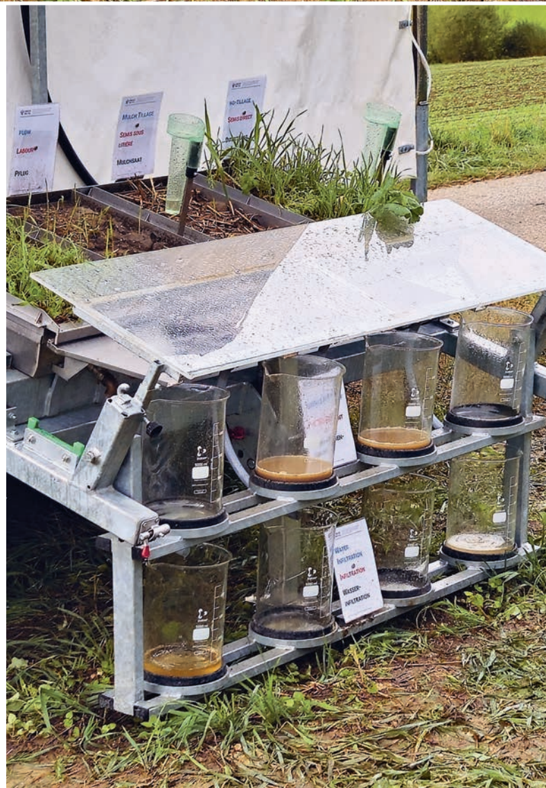
Ruissellement et infiltration de l'eau sur et à travers divers sols : prairie permanente, labour, semis sous litière et semis direct. Oberflächenabfluss und Wasserinfiltration auf und durch Böden: Dauerwiese, Pflug, Mulchsaat und Direktsaat im Vergleich.
