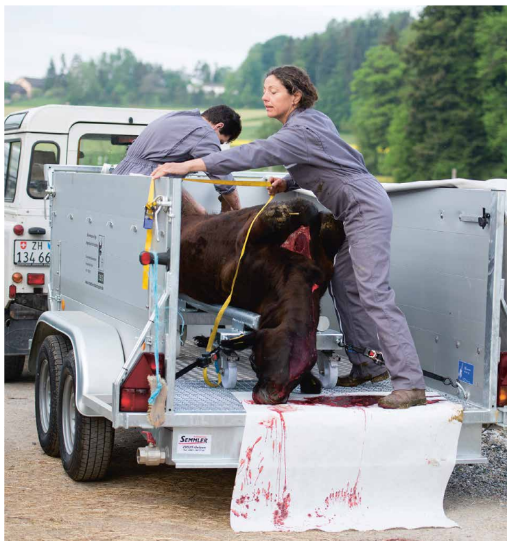
Conçue pour les abattages au pâturage en Allemagne, la T-Trailler est fabriquée en grande partie en aluminium et répond aux exigences fixées par le règlement de l'UE sur l'hygiène. Elle peut être attelée aussi bien à une voiture qu'à un tracteur. Cette remorque convient également au transport d'animaux mis à mort à la ferme.
