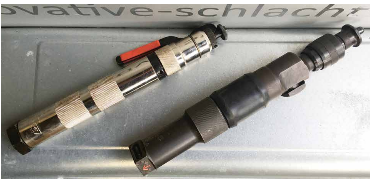
Le pistolet à tige perforante EFA Cash Magnum XL (.25cal) (à droite) est fabriqué en acier suédois et compte parmi les meilleurs appareils disponibles sur le marché. Le Magnum XL et le Magnum Freeflight ne disposent pas de système de rappel; ils atteignent, en revanche, une énergie d'impact majeure (en joules) et une vitesse de la tige supérieure.
