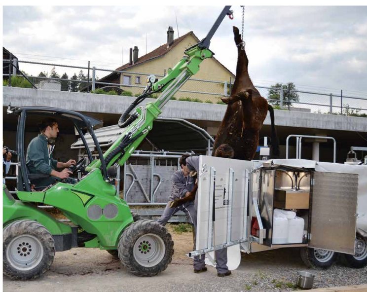
À l'aide d'un chargeur télescopique, le bovin saigné est posé sur son dos sur le châssis mobile à l'intérieur de la remorque (T-Trailer). Deux personnes aident à bien le placer.
