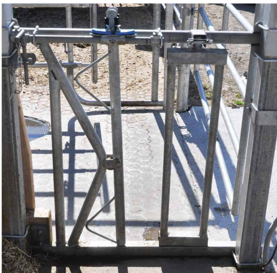
Le cornadis autobloquant est équipé d'un arceau auto-construit doté de leviers à serrage rapide.
