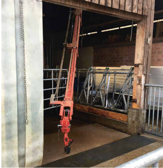
Place d'alimentation spécialement aménagée pour l'étourdissement, avec grue à foin et chaîne pour soulever le bovin étourdi.
