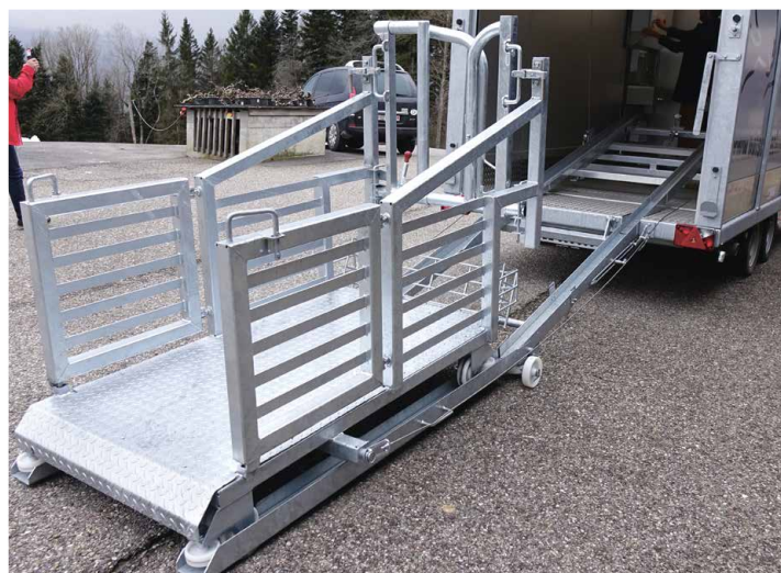
Le cornadis autobloquant rattaché à la MSE-200A est construit de sorte qu'il puisse être sorti de la remorque sur des glissières et décroché pour ensuite être de nouveau accroché le jour de l'abattage.
